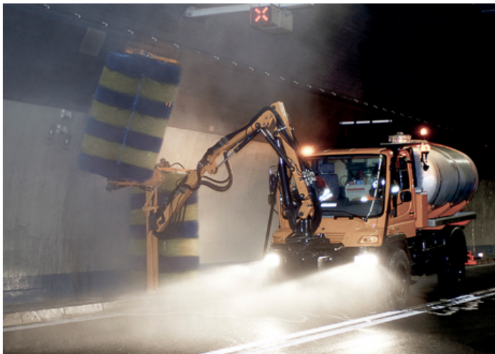
TUNNELREINIGUNG MIT SPEZIALFAHRZEUG
